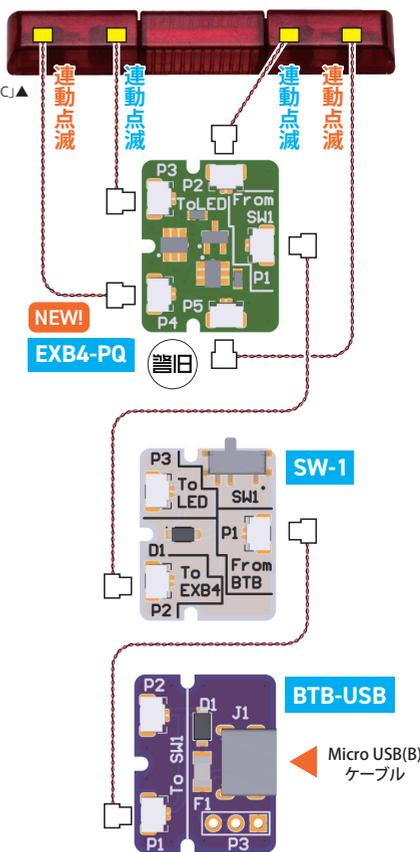
Micro USB(B)ケーブルで5V電気供給。
