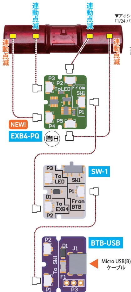
Micro USB(B)ケーブルで5V電気供給。
